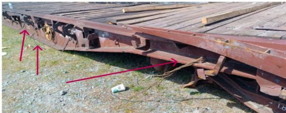
Φώτο 42. Διάτμηση των συρμάτινων δεσιμάτων των λαμαρινών
